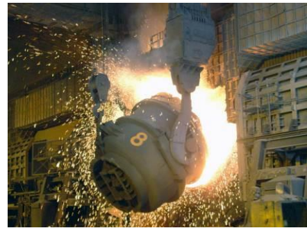
製鉄所での転炉工程 提供：JFE スチール(株)
